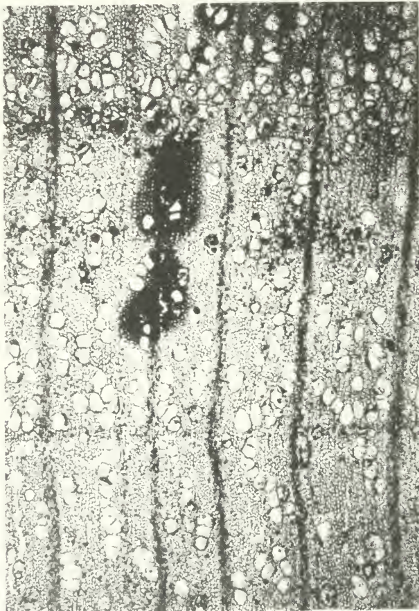
Abb. 6: Querschliff. Halbringporige Gefäßverteilung, Gefäße rundlich bis polygonal. 1984 I 206; x 45
